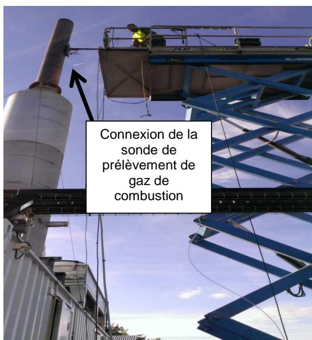
**Figure 37. Système d'échantillonnage à basse pression avec ligne chauffée des gaz de combustion.**
