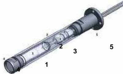
**Figure 2. Sonde pour un prélèvement basse pression dans la conduite de gaz.**
