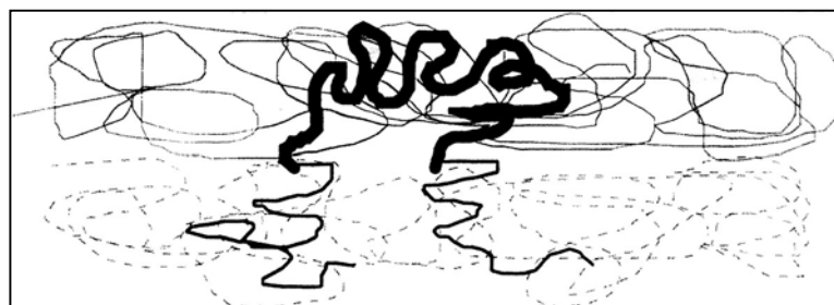
Figure III-6 – Compatibilisation par un copolymère tribloc. [Chiarilli-Sabin, 1996]
