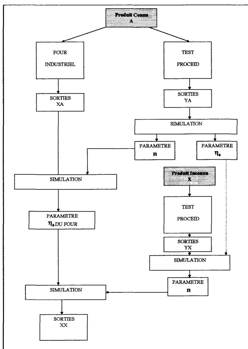
Cette procédure d'extrapolation permet effectivement la prévision des performances en destruction thermique et émissions pour déchets solides seuls ou en mélange, sur grand four d'incinération, et ce à partir de tests préalablement réalisés sur l'installation PROCEID. La précision attendue est inférieure à 10 %.
