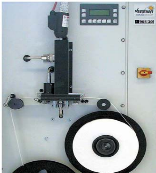
Figure 15 : Exemple de jauge à rayonnement \beta (F-904-20) (Schéma Durag)
