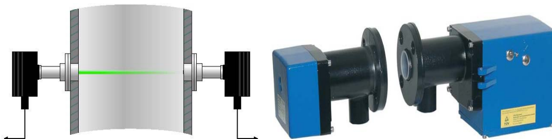
Figure 11 : Mesure optique par transmission (Schéma PCME et photo Durag)
