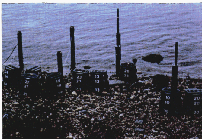
Etude des relations cours d'eau-nappe. Echantillonnage automatique dans les puits d'observation implantés dans la berge.
