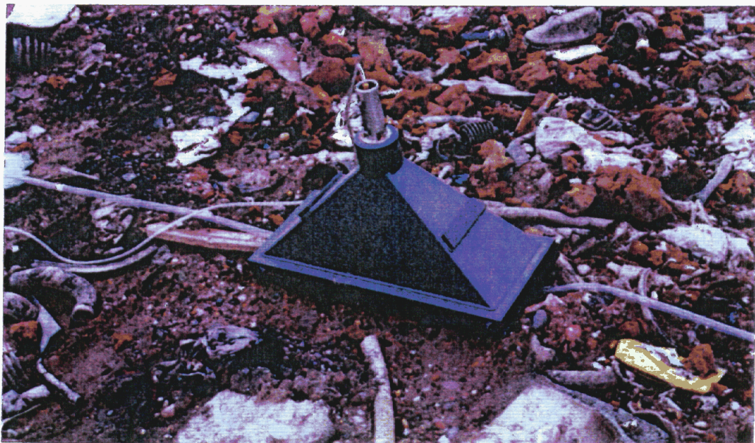
Photographie 14 : Expérimentation de contrôle de fuite sur la "chambre" sous pression d'Hélium posée sur un empilement de déchets réels.
