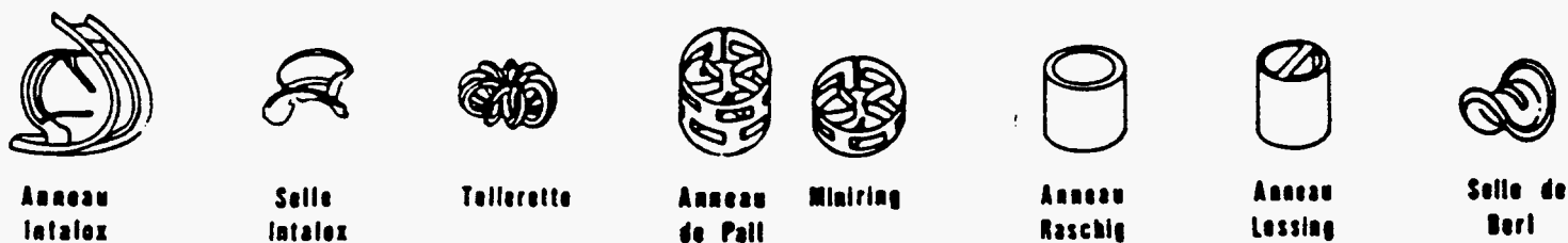
Figure 14 : Présentation de quelques garnissages utilisés dans le remplissage des contacteurs gaz-liquide du type colonnes garnies.
