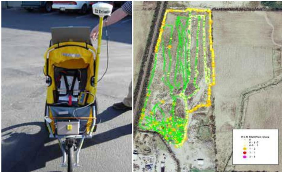
Figure 30 : Exemple de dispositif de mesures de gaz du sol et de cartographie des teneurs mesurées en cyanure d'hydrogène à l'aide de l'outil logiciel FIELDS (Bing Canar, 2008).
