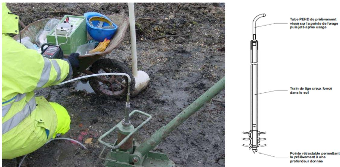
Figure 28 : Exemple de dispositif de prélèvement de gaz du sol et de mesure des COV par un détecteur par photo-ionisation (PID) (Delcausse & Belbeze, 2003).
