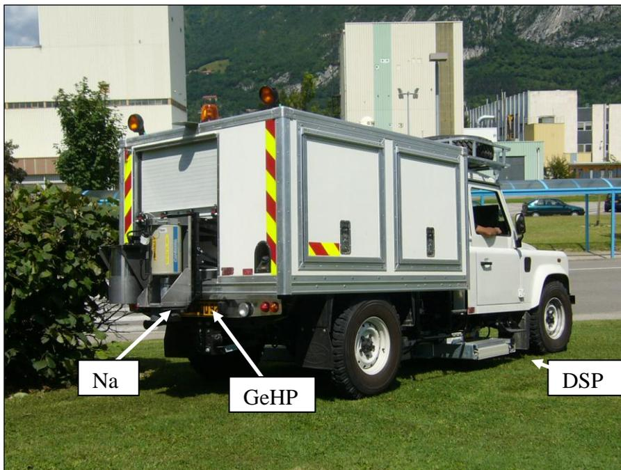
Figure 40 : Le véhicule VEGAS d'acquisition des données surfaciques de radioactivité.
