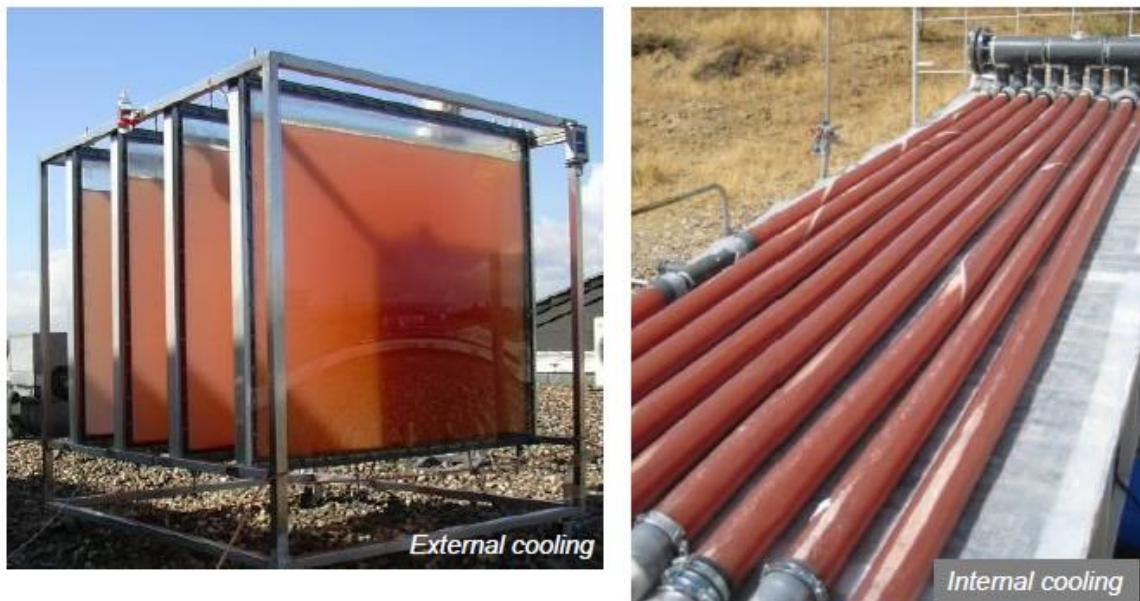
Figure 36. Photobioprocédés à l'échelle pilote de photofermentation installés pour la production d' H_2 dans le cadre du programme Hyvolution, soit en panneau (4x25L) à Aachen, Allemagne ou tubulaire (80L) à Ankara, Turquie [77]
