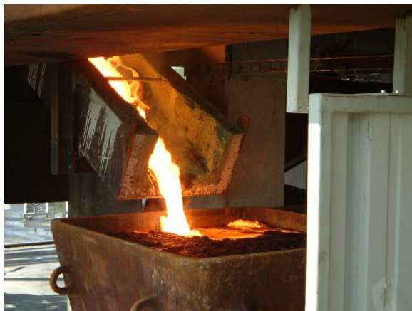
Figure 72 Coulée de COFALIT
