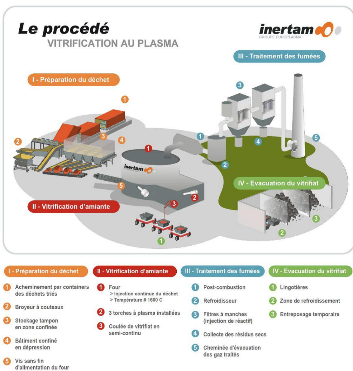
Figure 71 Le procédé de vitrification au plasma (Source : Inertam)
