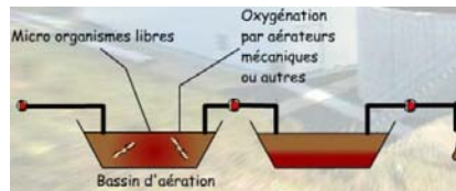
Figure : Traitement des lixivats par lagunage aéré. (ARCADIS)
