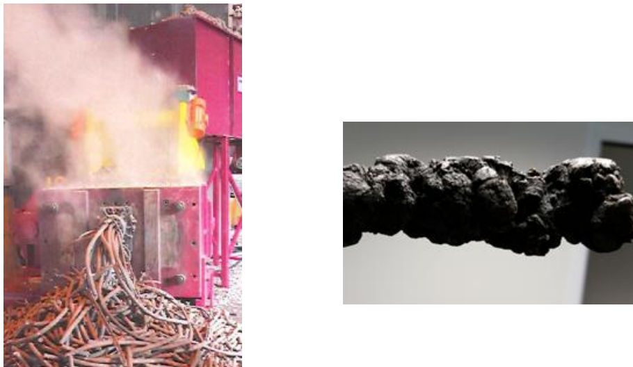
Figure 102 : Essai de pelletisation d'un mélange CSR, avec extrusion perturbée par élément métallique avec début de combustion dans le corps de la filière d'extrusion
