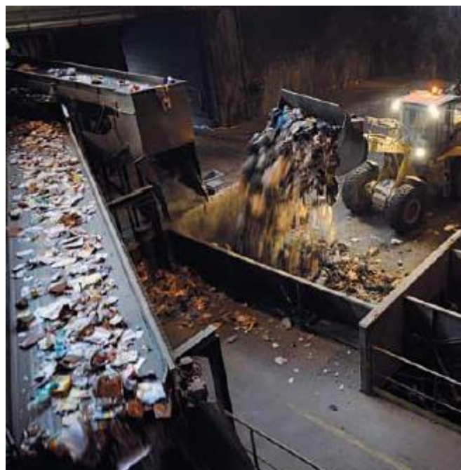
Figure 8 : Une chargeuse alimente un convoyeur de déchets (d'après la revue Travail et Sécurité (2010)).
