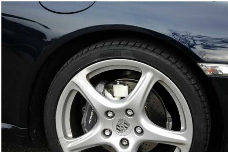
Figure 34 : Dispositif d'aspiration des poussières sur les roues en développement pour les voitures (d'après Auto Plus, 2014)
