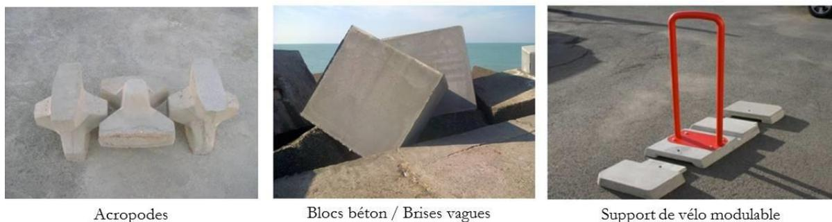
Figure 9 : Exemples de mobilier urbain élaboré à partir de sédiments : à gauche acropodes (Aqua *et al.*, 2013) ; au centre bloc béton / brises-vagues à Dunkerque (Herman *et al.*, 2014a) ; à droite support de vélo modulable (SITA Nord & Doublet, 2014)
