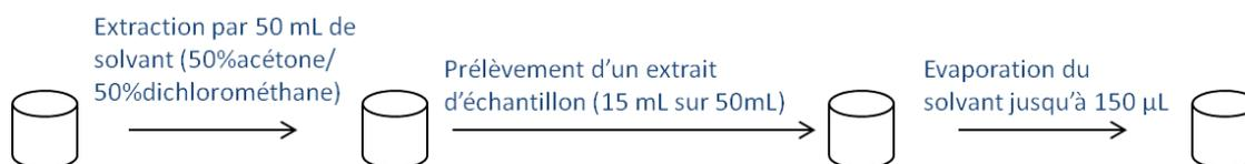
Figure 17 : Etapes de prétraitement des échantillons
