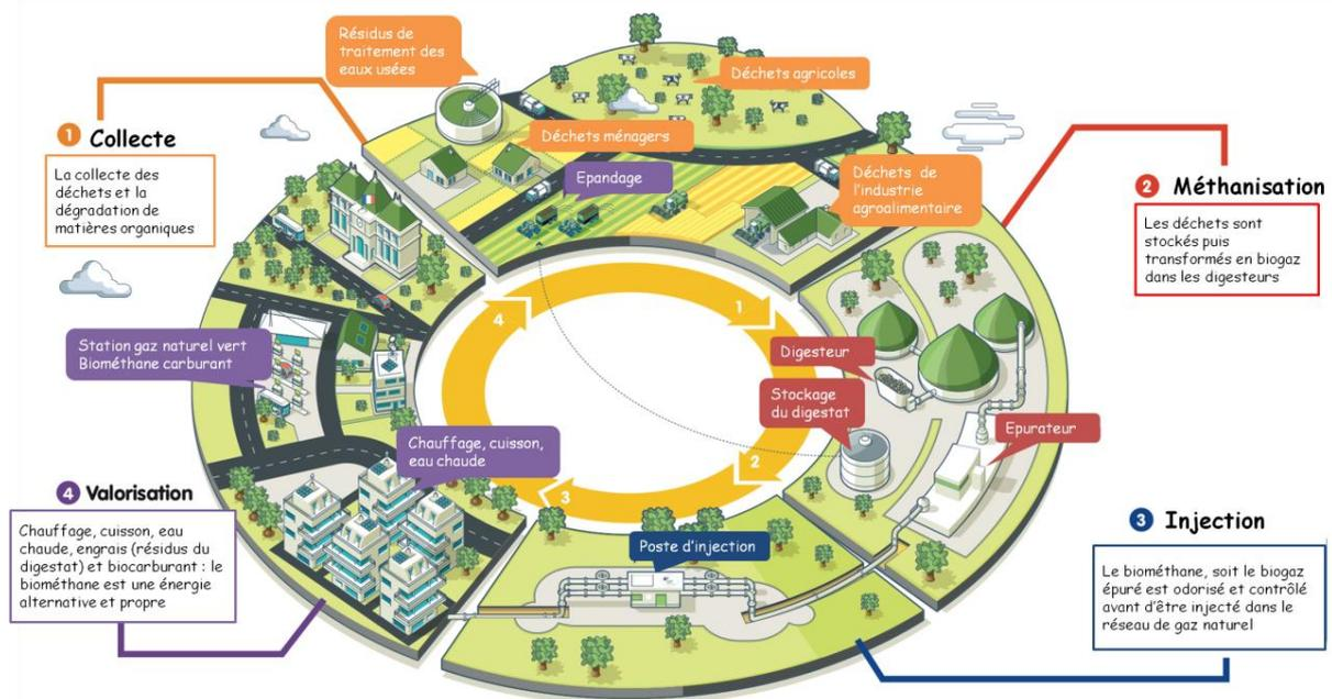
Figure 2 : Schéma de production et valorisation du biométhane(<http://www.grdf.fr/>)
