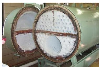
Figure 19 : Dépôts dus aux composés siliciés sur les brûleurs [AFT 2005].
