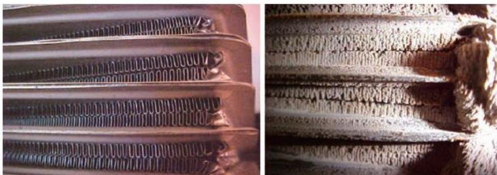
**Figure 26 : Pièce de microturbine avant et après exposition à du biogaz contenant des COVSi. Reproduit de [Wilbur 2008]**
