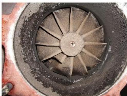
**Figure 27 : Impact de la corrosion acide et des dépôts solides sur une hélice de turbine. Reproduit de [Urban et al. 2009]**
