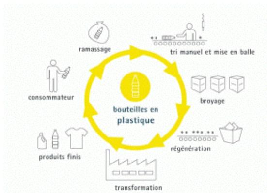
Figure A2-1 : Procédé recyclage mécanique
