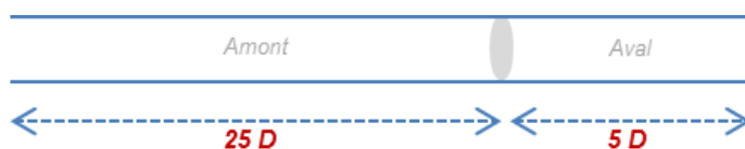
Figure 13 : Longueurs droites et profil des vitesses établi
