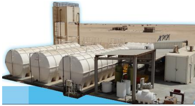
Photo 2 : Unité de distillation membranaire à Al Najdah [91]
