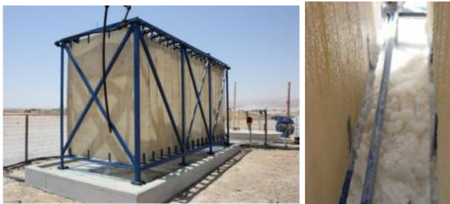
Photo 5 : WAIV™ unité pilote avec cristallisation de sels – Israël [109]
