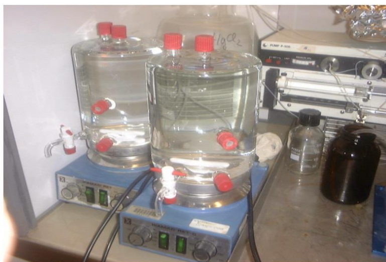
Figure 8 – Dispositif expérimental pour un essai de contact NAPL/eau (Côme et al., 2005)
