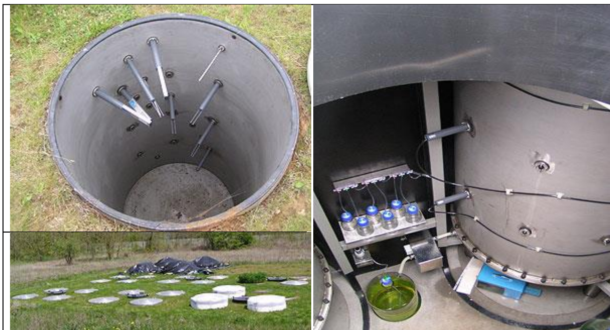
Figure 6 - Vue d'extérieur et d'intérieur des lysimètres du GISFI
