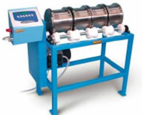
Figure 16 : dispositif Micro-Deval utilisé dans le cadre du projet PIMAC (BRGM)
