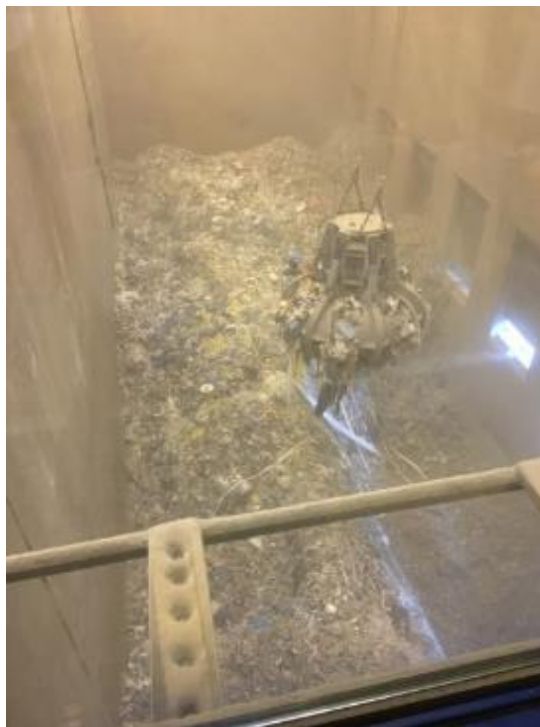
Figure 111: RDF dans l'aire de stockage (RECORD, 2018)
