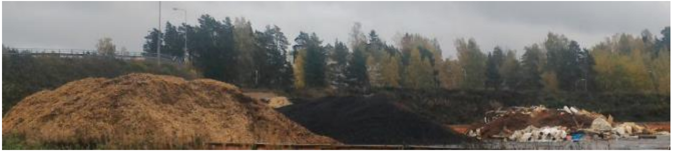
Figure 94 - Combustibles d'entrée (de gauche à droite) : 1) bois recyclé 2) boues déshydratées 3) déchets internes avant broyage (RECORD, 2018)
