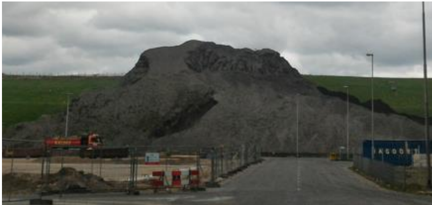
Figure 34: Mâchefers traités certifiés en technique routière (RECORD, 2018)
