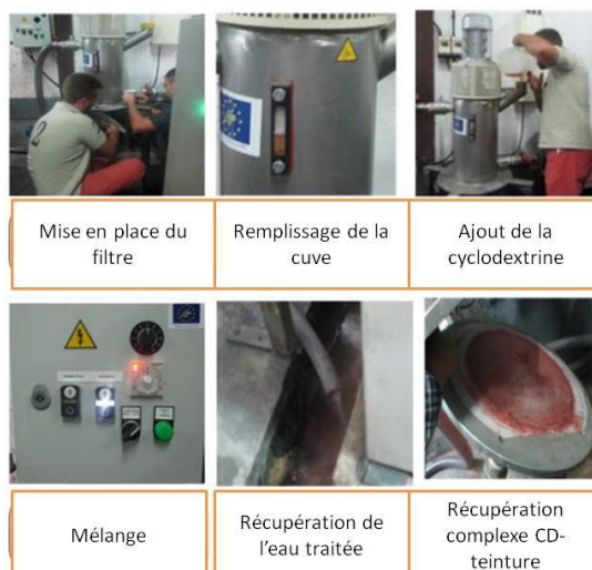
Figure 13 : Etape du traitement de l'effluent
