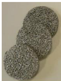
Photo 4. Catalyseur supporté par des disques (diamètre de 20 cm et épaisseur de 0,5 cm) [110, 111]
