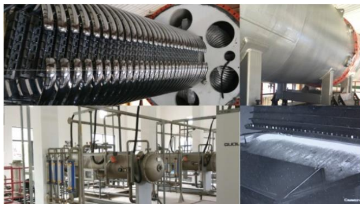
Photo 6. Procédé par faisceau d'électrons de l'unité chinoise de Jinhua. Photo de l'institut de technologie nucléaire et énergétique, Université Tsinghua, Beijing [207]
