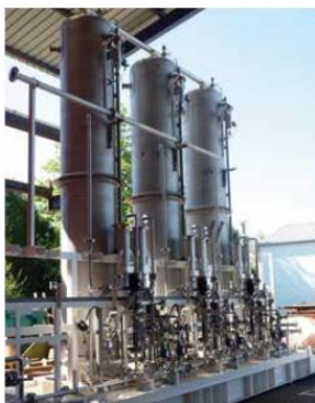
Photo 5. (de gauche à droite) unité OCS mobile 2 m 3 /h - unité mobile OCS 100 L/h (pilote industriel) - unité OCS 20 m 3 /h (images fournies par SEREP)
