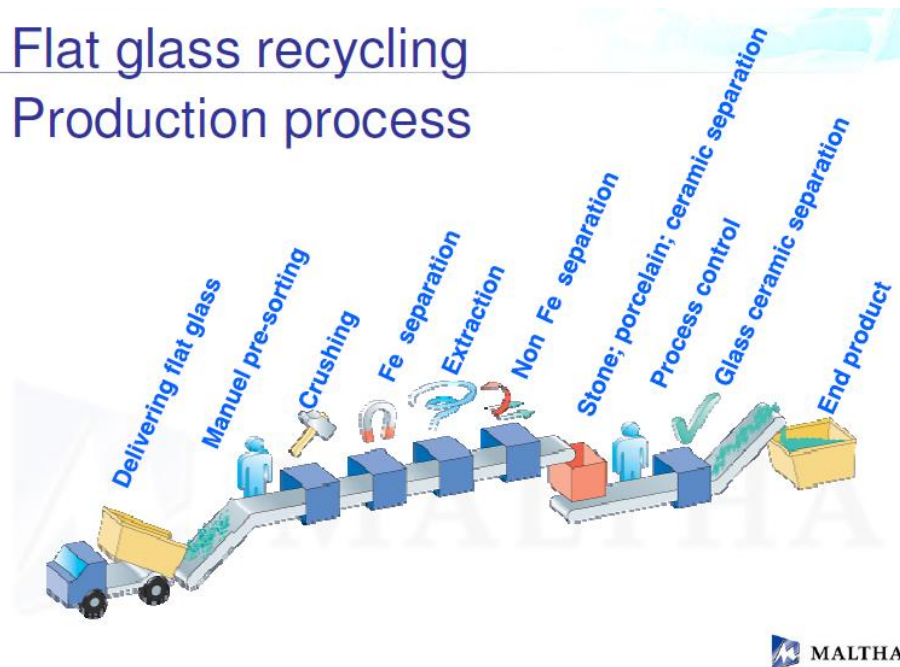
Figure 57 - Schéma du procédé de recyclage du verre par Maltha
