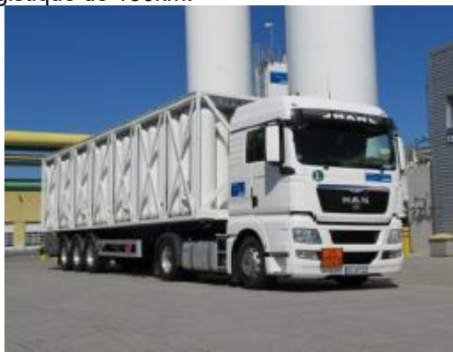
Figure 31 Transport d'hydrogène gazeux comprimé (Crédit Linde)
