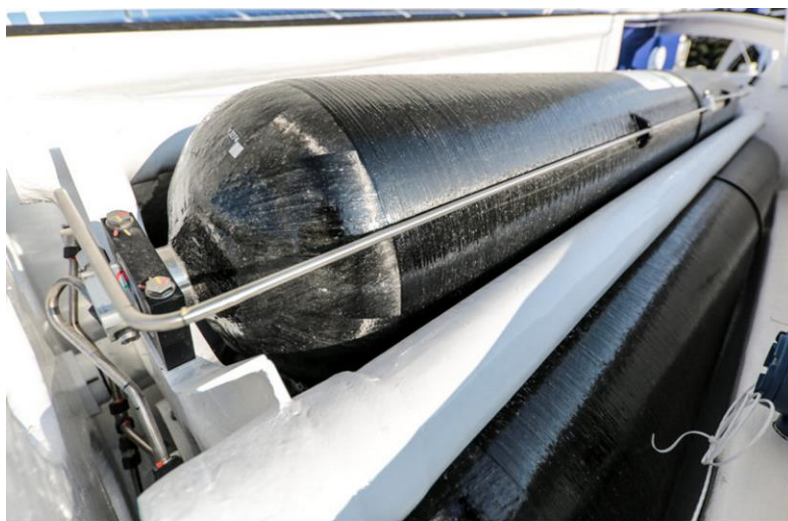
Figure 19 Illustration d'un réservoir d'hydrogène comprimé de type III intégré (bateau) – Source CEA – Energy Observer
