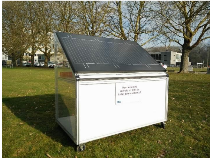
Figure 196 - Vue d'un panneau produisant de l'hydrogène alimenté par rayonnement solaire - Crédit Université Catholique de Louvain (2020)
