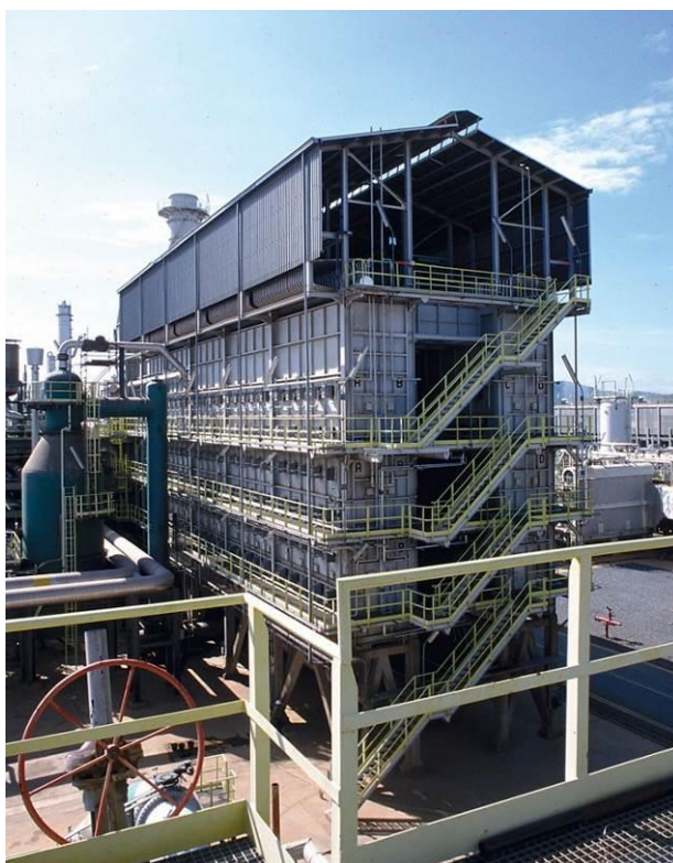
Figure 44 - Vue d'un vaporéformeur conventionnel à combustion de gaz, source Haldor Topsoe
