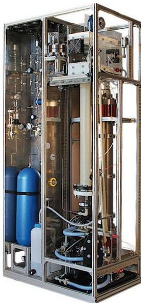
Figure 146 -Solution Hyris-lab de production de H 2 à forte pression. Source Ergosup
