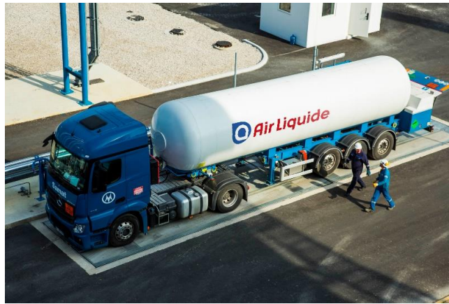
Figure 32 Transport d'hydrogène cryogénique (crédit Air Liquide)
