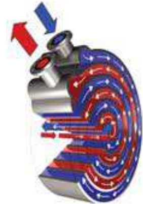
Figure 18 : Schéma de principe de circulation des fluides
