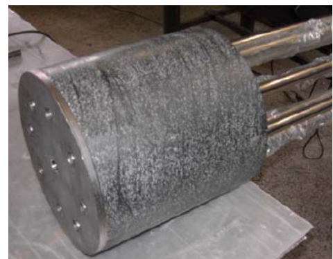
Figure 28 :échangeurs avec matrice Graphite/MCP intégrés [7]
