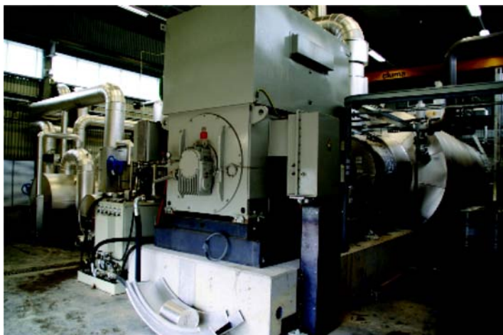
Figure 12 : Installation ORC de 2,5 MWe de TURBODEN sur des excédents du réseau de chaleur de l'incinérateur de déchets MIROM, Roeselare (Roulers)
