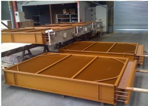
Echangeur avec traitement spécial anti -corrosion
