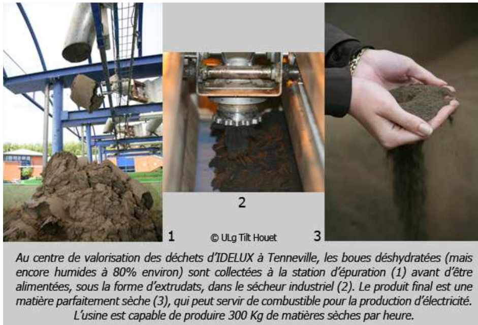
Figure 28 : Exemple d'une chaîne de traitement des boues
