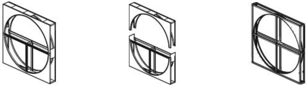
a) Carter une seule pièce en tôle d'acier
