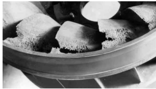
Figure 9 : Photo d'une turbine ayant subi un endommagement sur ses pales par un phénomène de cavitation
