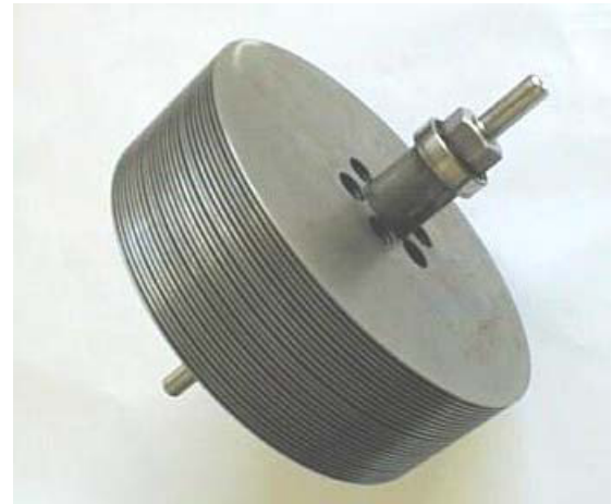
Figure 3.2 : Assemblage des disques sur l'arbre d'une turbine Tesla
