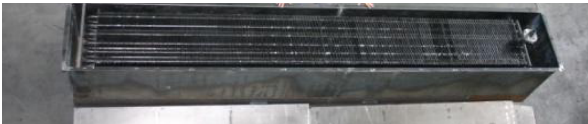
Figure 49 : Vue de dessus du prototype du système de stockage PCM /ailette de graphite
