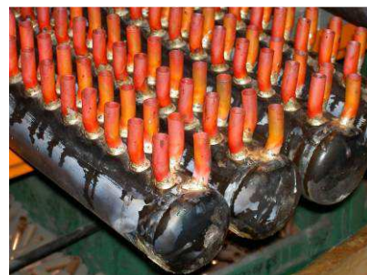
Figure 23 : Collecteur entrée ou sortie
