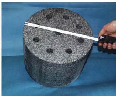
Figure 28 :échangeurs avec matrice Graphite/MCP intégrés [7]
