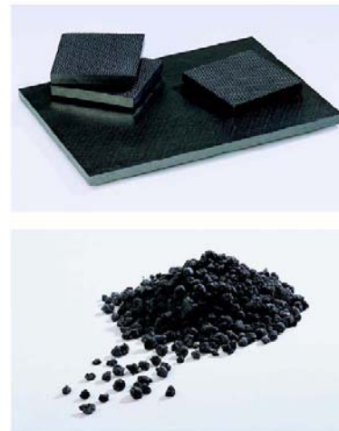
Figure 18 : matrice PCM/graphite (haut) et composé PCM/graphite (bas) [SGL]
