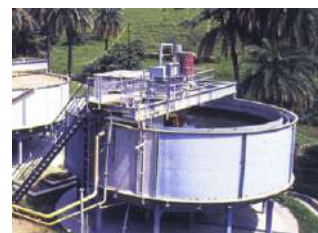
Épaississeur à râteau permettant la sédimentation – Mineral Exploration (Second Edition)
