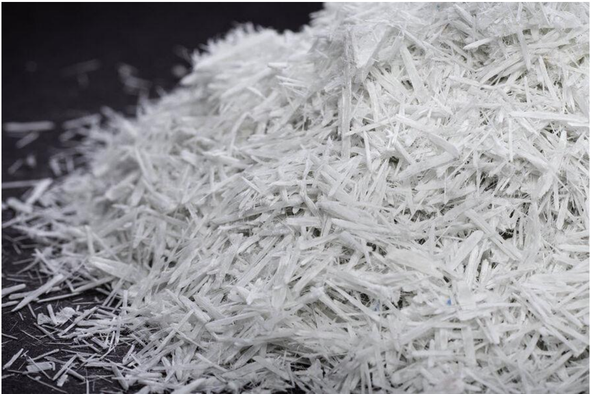
Fibres de verre recyclées selon le procédé de Regen Fiber (source : Regen Fiber , 2023).
