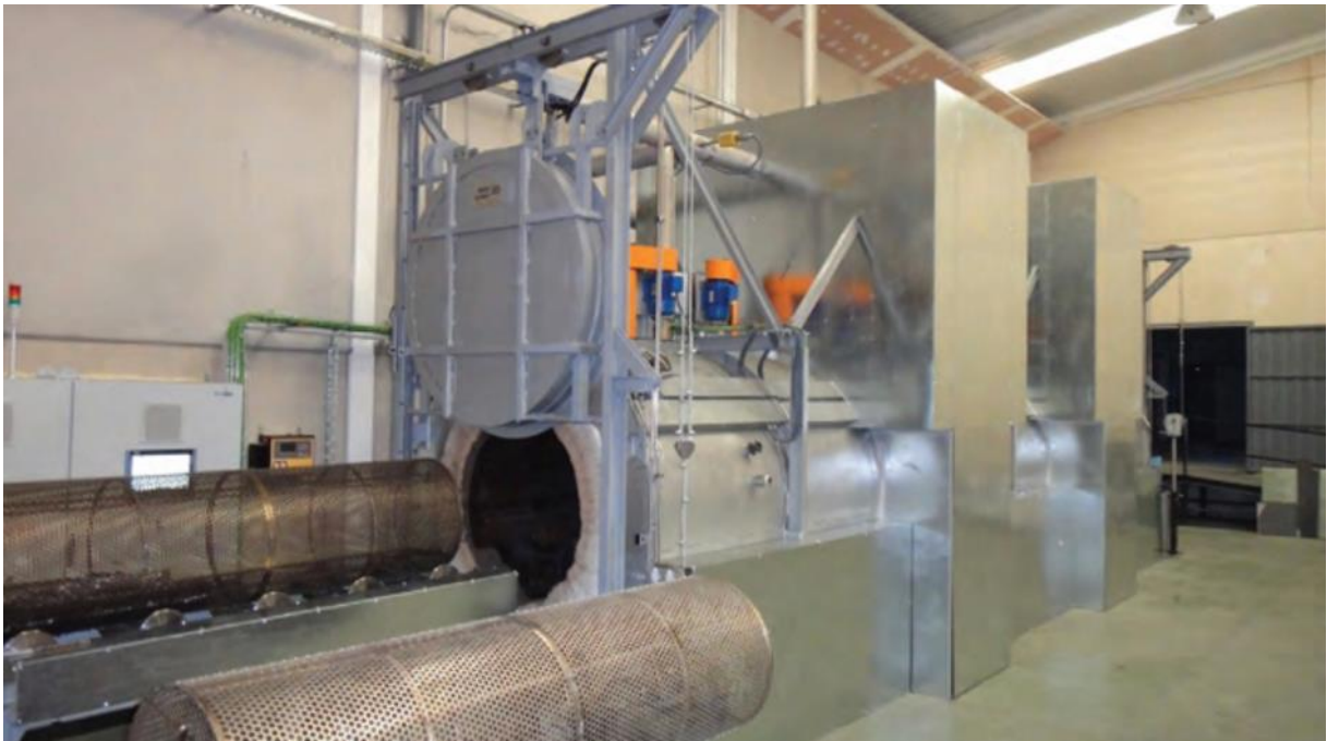
La technologie CRS (Composite Recycling System), un procédé thermique pour séparer les résines des fibres (source : Environnement Magazine , n° 1793, janvier 2022).
