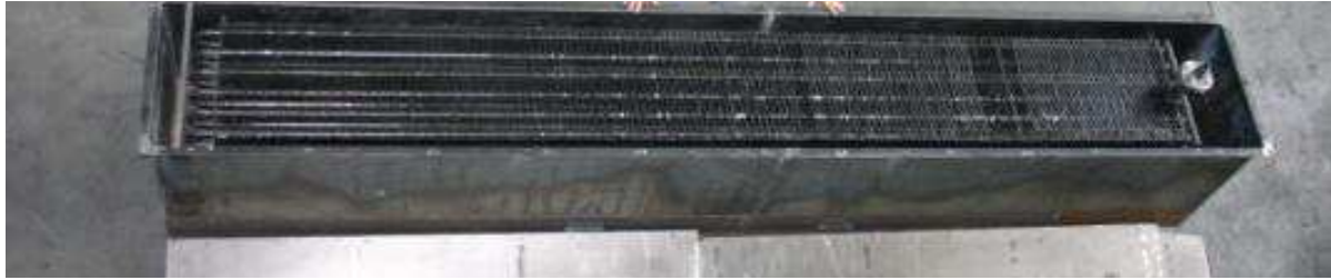
Figure 33 : Vue de dessus du prototype du système de stockage PCM /ailette de graphite
