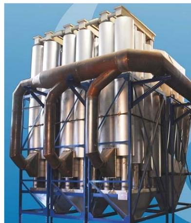
Ainsi, la diminution du rayon des cyclones permet d'augmenter l'accélération centrifuge, et donc la séparation des particules de l'effluent gazeux à traiter. Par conséquent l'utilisation de nombreux cyclones de quelques dizaines de centimètre de diamètres en batterie, appelés multicyclones, permet d'augmenter l'efficacité du système.
