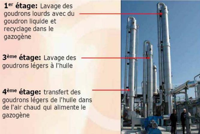
**1<sup>er</sup> étage:** Lavage des goudrons lourds avec du goudron liquide et recyclage dans le gazogène
