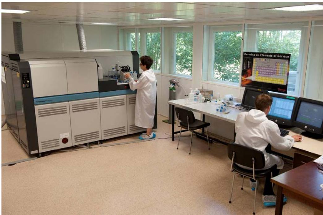
Figure 7 : Vue d'un spectromètre de masse à plasma à couplage inductif et multicollecion ICP-MS-MC Neptune
