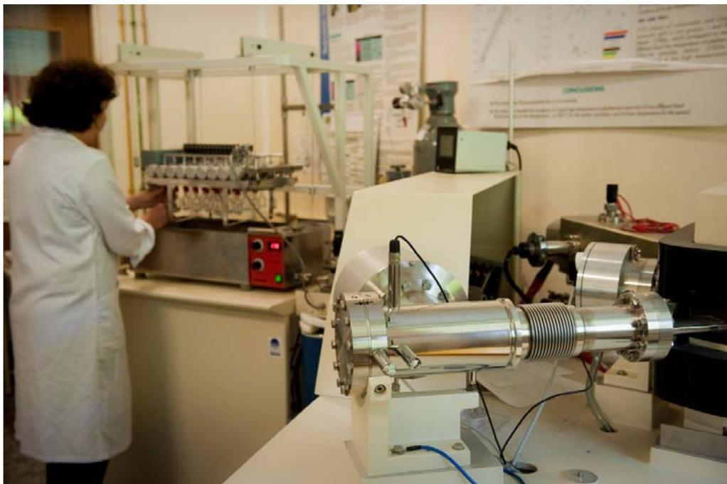
*Figure 5 : Vue d'un spectromètre de masse à source « gazeuse » IRMS*
