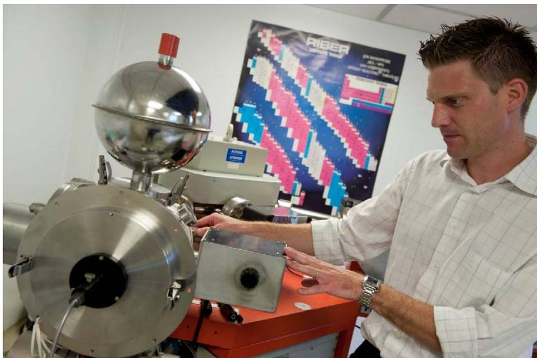
*Figure 6 : Vue d'un spectromètre de masse à source « solide » TIMS*
