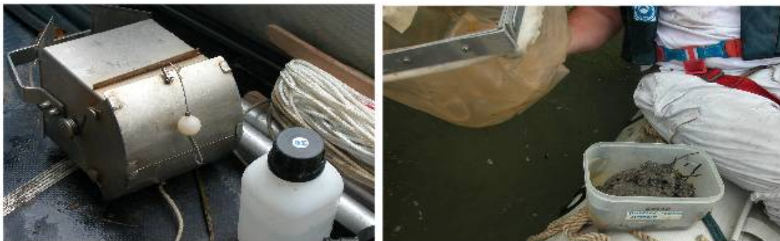
Figure 13: Matériel de prélèvements des sédiments pour l'étude des Oligochètes à gauche : benne Ekman ; à droite, exemple de prélèvements
