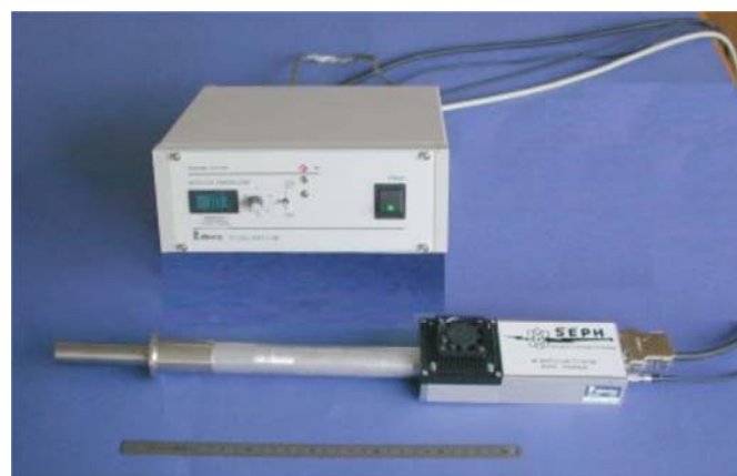
Figure 62 : Le détecteur SDD et l'unité d'alimentation qui assure l'amplification
