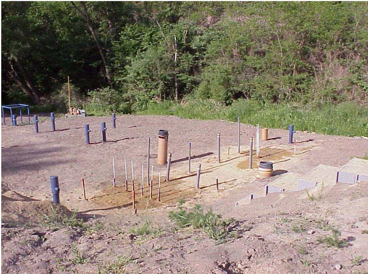
Figure 7 – Photographies de la BPR pilote de Pécs en Hongrie avec les puits de surveillance (Csöväri et al., 2004)
