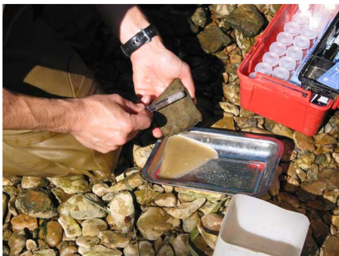
Fig. 2 : Echantillonnage des diatomées au moyen d'une brosse à dents.
