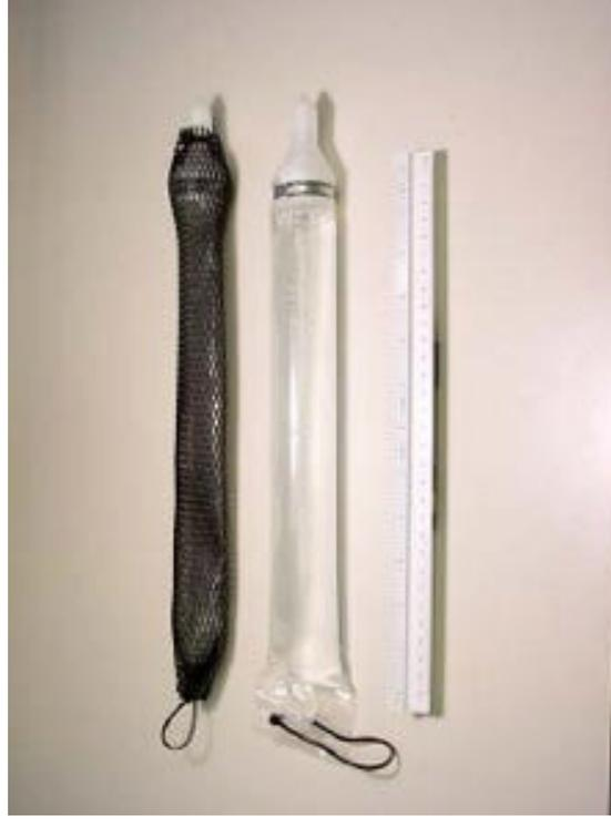
Figure 11 : PDB Polyethylene Diffusion Bag Sampler
