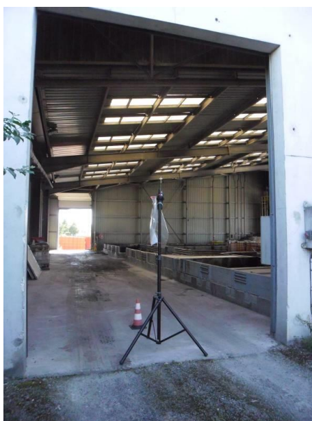
Figure 6: suivi continu par analyseur PID des concentrations indicatives à l'émission des bâtiments – exemple de mise en œuvre
