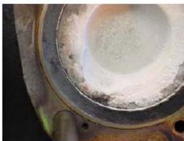
**Figure 4 : Dépôts sur une couronne de piston**
