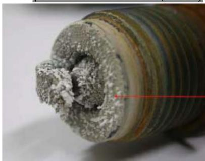
**Figure 5 : Dépôts et usure précoce d'une bougie**
