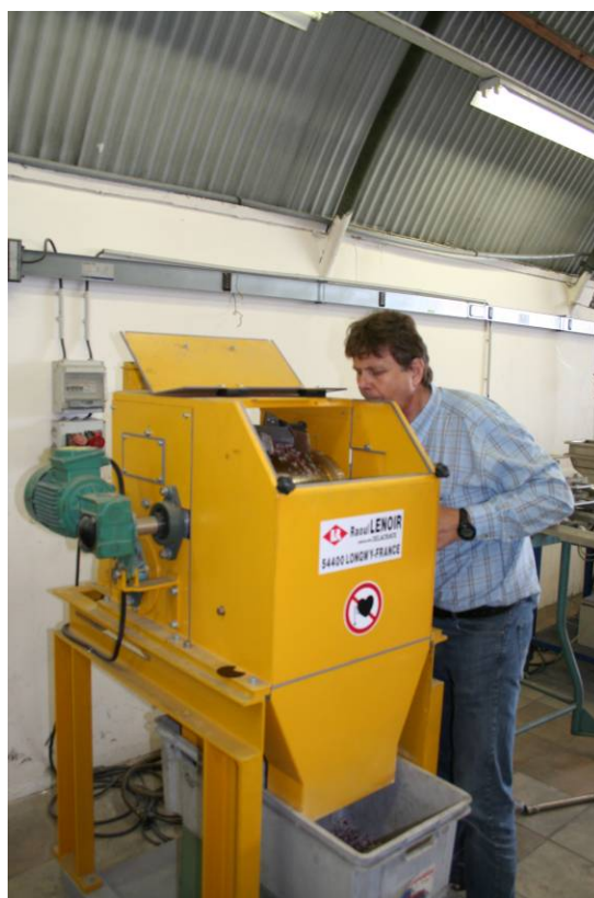
Figure 19, Photographie de l'essai sur la machine RELAP
