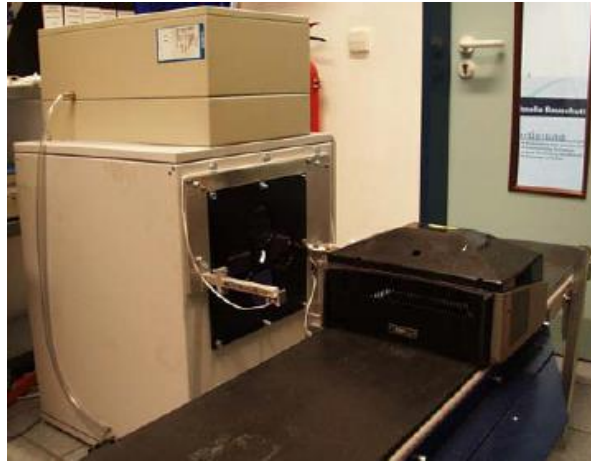
Photo 7 : Spectromètre MIR AOTF automatisé développé par ICB
