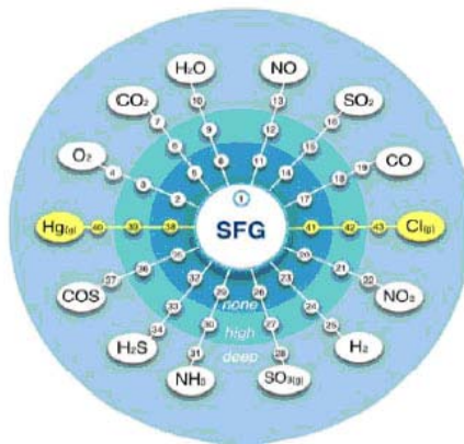
Figure 7 : Standardrauchgas (SRG) Berechnungsablauf.
