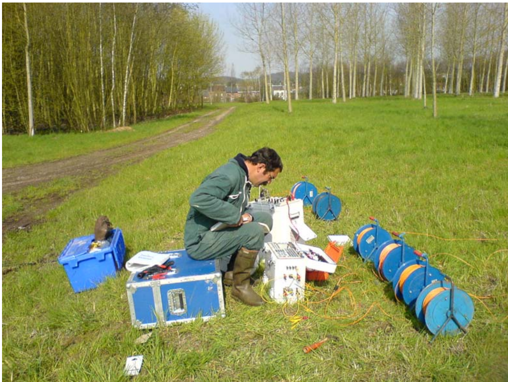
Figure 11 : Séance de mesure en polarisation provoquée spectrale. Les bobines sont connectées aux différentes électrodes
