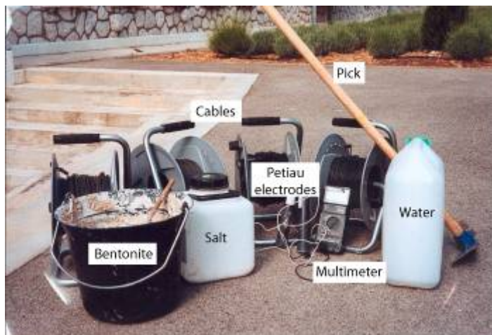
Figure 1 : Equipement de potentiel spontané : les électrodes, le multimètre, les câbles, eau, sel et bentonite pour améliorer le contact électrique des électrodes si nécessaire
