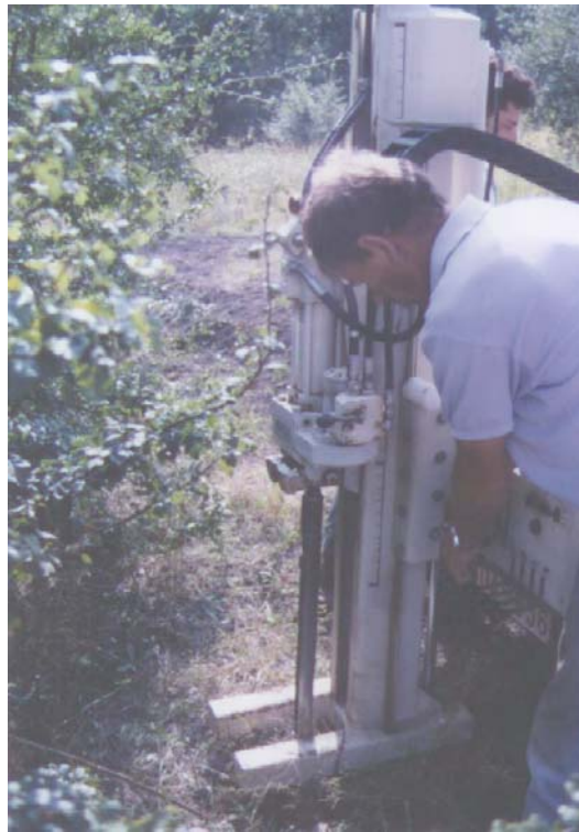
Figure 19 : Tube à lumières enfoncé à la sondeuse à percussion (Wavrer, 1997)
