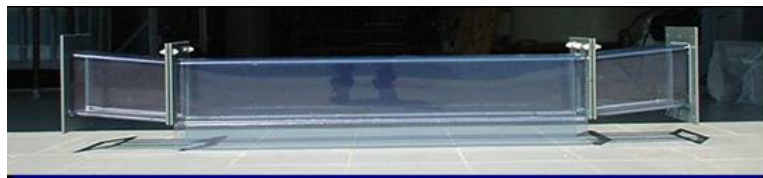
Figure 5.4 : Exemple d'une chambre à flux dynamique (données Ecole des Mines d'Alès et EOG)
