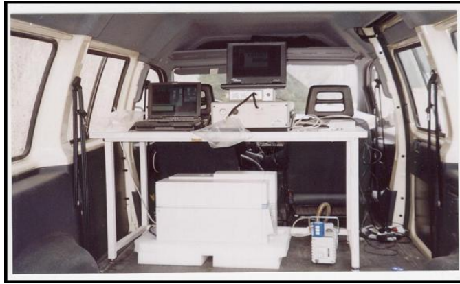
Figure 6.5 : Couplage \mu TD/ \mu GC/MS en fonctionnement sur site (dans une voiture break).
