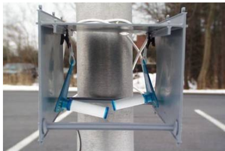
Figure 5.10 : Installation des montages d'accumulation statique
