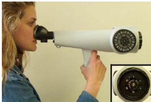
Figure 7.2 : Dispositif « nasal ranger », olfactomètre portable permettant de déterminer, dans l'environnement, des faibles intensités d'odeurs.
