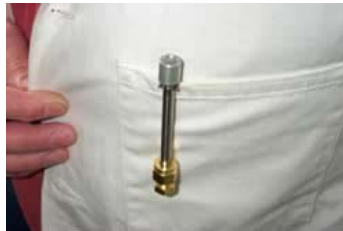
Figure 5.7 : Exemple de tube porté comme badge en tant qu'échantillonneur passif (site Markès)
