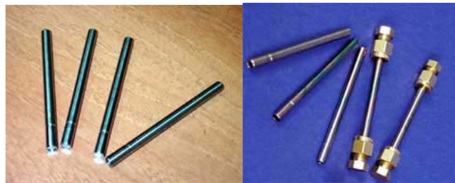
Figure 5.6 : Exemple de tubes (inox à gauche et silcosteel à droite) pour prélèvement dynamique et extraction thermique (Site markès)
