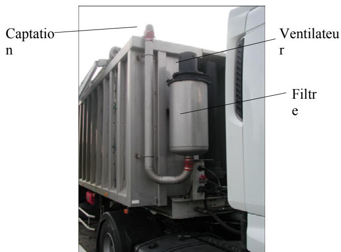
Figure 9.2.4 : Transport de déchets d'animaux : Dispositif de traitement par adsorption
