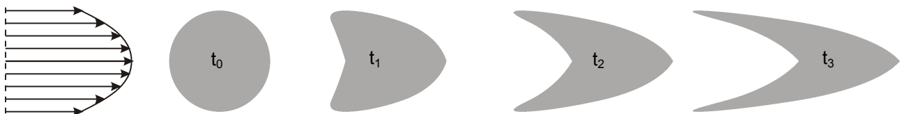
Figure 9 : Illustration de l'effet d'un gradient de vitesse sur la dispersion d'une bouffée de polluants. Les figures de gauche à droite représentent les formes successives d'une bouffée de polluants initialement circulaire.
